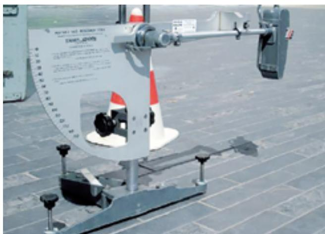
Outil de mesure de l'adhérence d'un revêtement (type pendule SRT via la norme XP CEN/TS 16165 : source : CRR)
