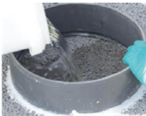
Protocole de mesure in situ (ASTM C1701 – © CIMBETON référence Guide T69)
