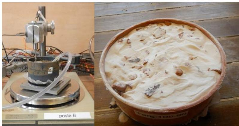
Figure 2.A : Courbe de désorption : matériel de mesure, B : désorption des éléments grossiers (> 2 mm) inclus dans un lit de microbilles)
