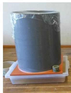
Figure 1. Cylindre utilisés pour la réalisation du protocole ASVE
