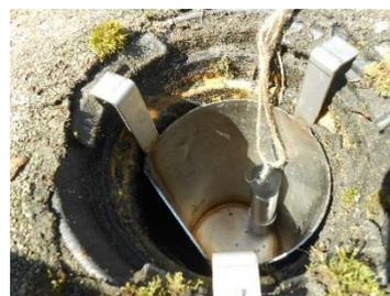
Figure 2. Déversoir cylindrique pour mesure de débit sur toiture
