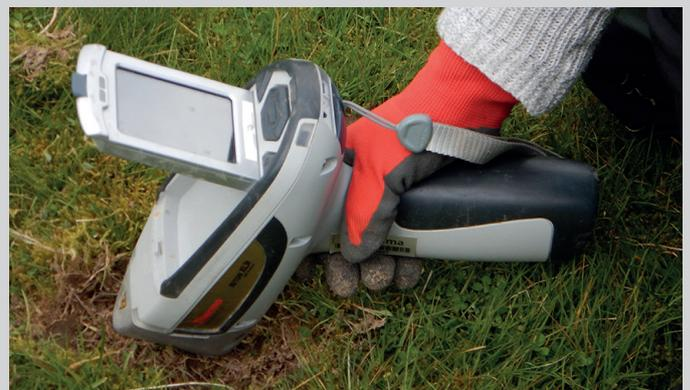
> Spectromètre à fluorescence X ©Cerema Ile-de-France
